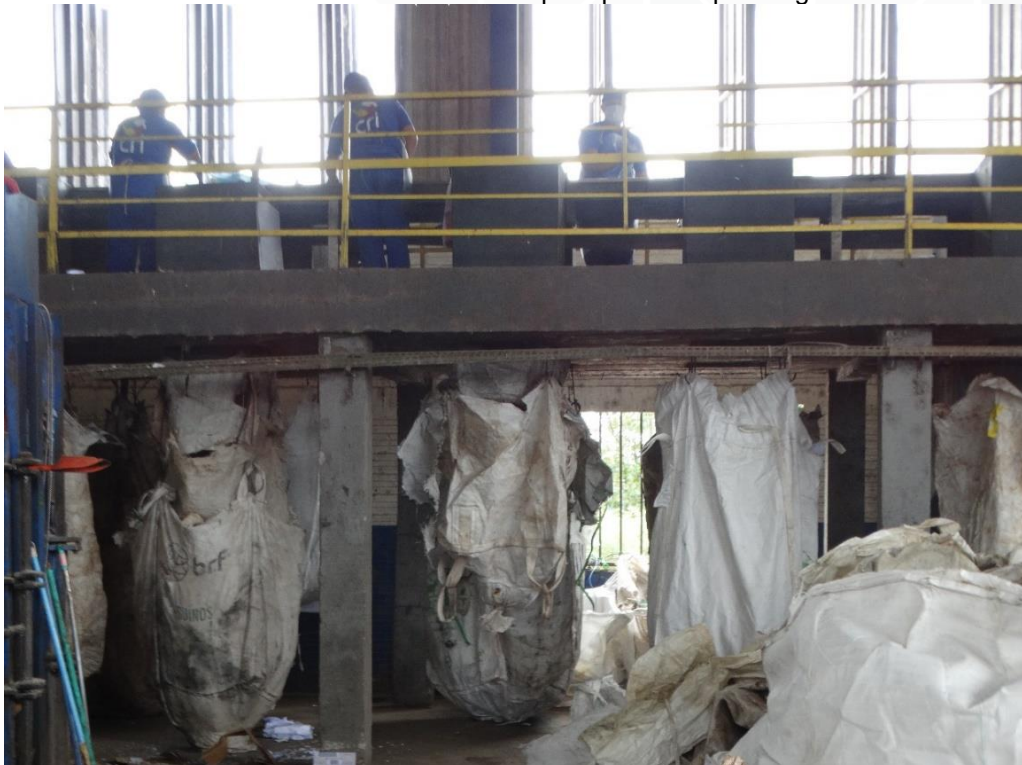
Figura 79: Método de acondicionamento de resíduos para posterior prensagem.
