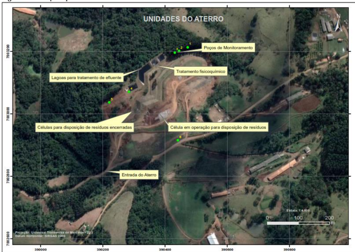
Figura 85: Disposição das estruturas no aterro sanitário.
